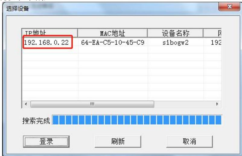
可以看到有 2 个 TS-180 设备在局域网上，显示设备的“IP 地址”、“MAC 地址”、“设备名称”、“网关地址”及“子网掩码”。
