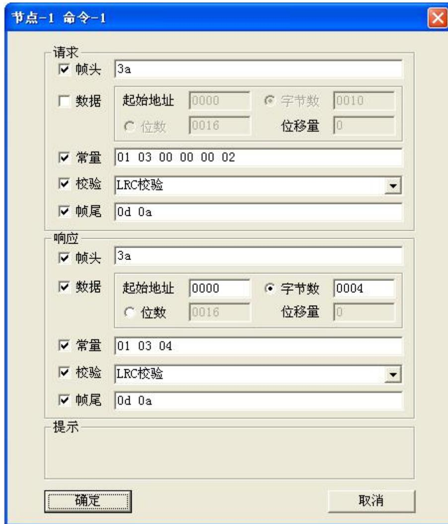
注：在 ASCII 传输格式下，校验支持：无校验、LRC 校验、和校验
