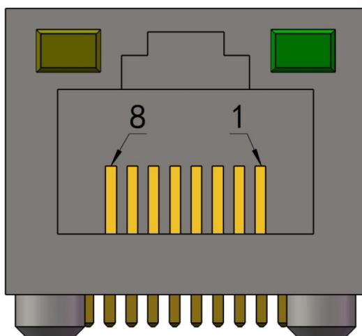
以太网接口采用标准的 RJ-45 接口，其引脚定义如下：
