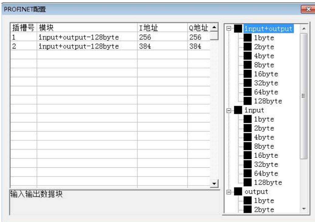
可以看到，上述一共配置了 2 个槽位，分别：128 字节输入输出、128 字节输入输出。
